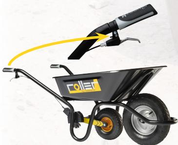
Die **anzuhebende Last** wird auf das Hauptrad und die Schwenkrolle verteilt. Die Schwenkrolle ist höhenverstellbar und wird durch den im Handgriff integrierten Steuerhebel betätigt.
