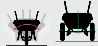
Optimale Stabilität und ideale Lastverteilung auf der Achse dank der beiden Rädern.
