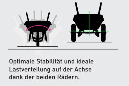
Optimale Stabilität und ideale Lastverteilung auf der Achse dank der beiden Rädern.
