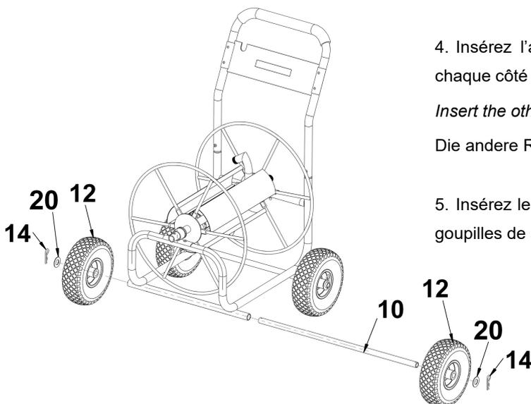
4. Insérez l'autre axe de roues (10) dans les logements prévus de chaque côté à l'avant du châssis.
