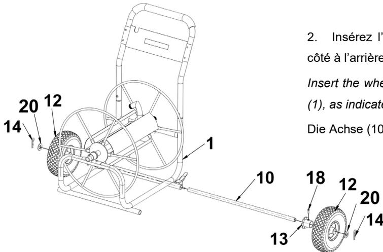
2. Insérez l'axe de roue (10) dans les logements prévus de chaque côté à l'arrière du châssis (1).
