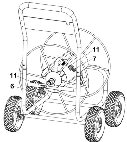
9. Mettez en place le raccord rapide (8) sur le tuyau d'alimentation en eau (non inclus), connectez-le au raccord tournant d'entrée (6). Branchez l'autre extrémité du tuyau à l'arrivée d'eau.
