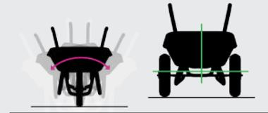
Optimale Stabilität und ideale Lastverteilung auf der Achse dank der beiden Rädern.
