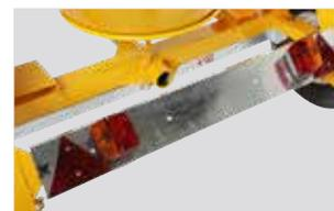
Komplett demontierbare Beleuchtungsleiste.
