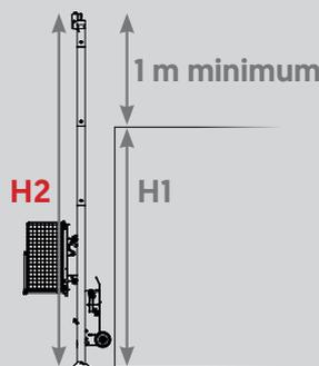
Pour une installation à la verticale, toujours prévoir au minimum 1 m d'échelle en plus de la hauteur de déchargement souhaitée.
